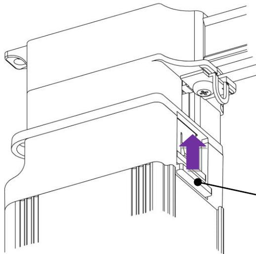
Prüfen Sie ob der Motor korrekt verriegelt ist und sich das Gehäuse nicht drehen kann.
